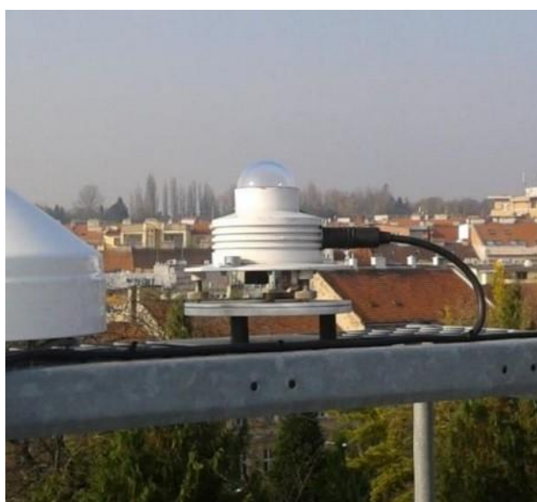
Obrázek 11 Širokopásmový radiometr UV-Biometr 501 používaný na stanici Brno-Kotlářská pro měření erytemového ultrafialového záření 22
