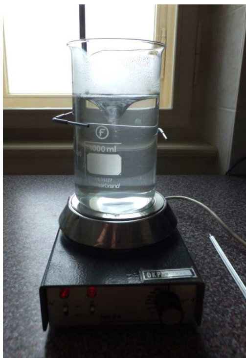
Foto. 3: Laboratorní míchadlo s ohřevem (Kultová, 2015)
