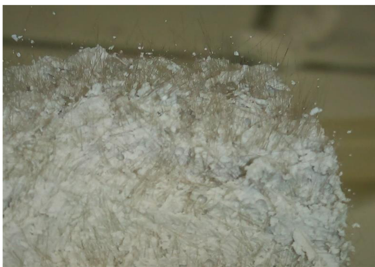
Obrázek 7: Pohled na příčný lom zkušební vzorku vyztuženého čedičovými vlákny
