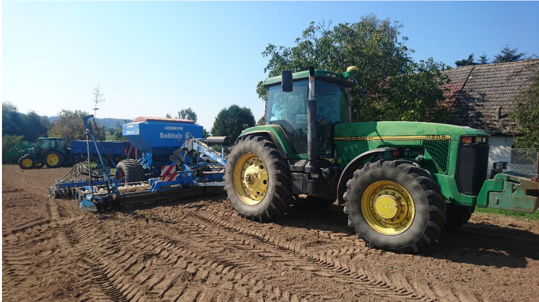
Příloha 9: Sečí stroj Lemken Solitair 9 v agregaci s John Deerem 8200
