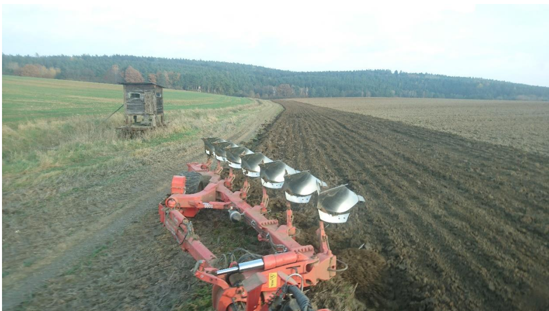
Příloha 7: Zpracování půdy sedmi radličným otočným pluhem Kuhn Vari Leader
