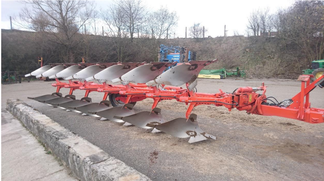
Obrázek 3: Otočný oboustranný sedmi radličný pluh Kuhn Vari - Leader
