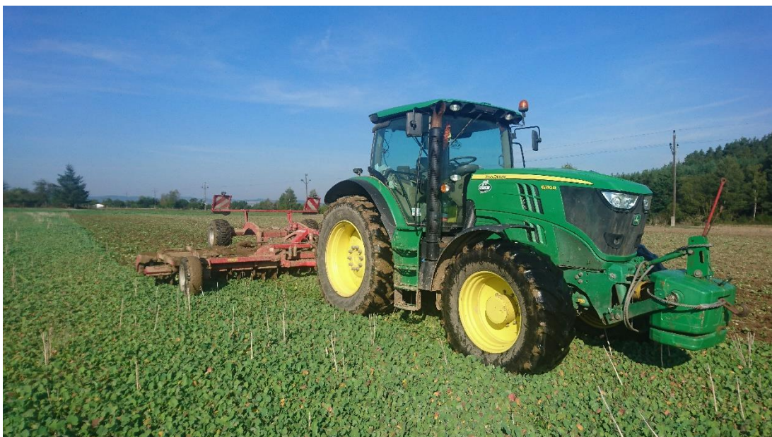
Příloha 5: Zpracování půdy talířovým podmiřákem Horsch Joker 6RT tažený kolovým traktorem John Deere 6210R
