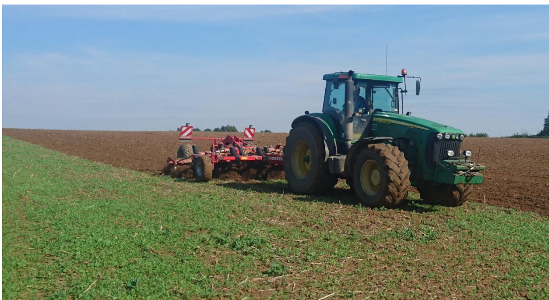
Příloha 6: Zpracování půdy radličkovým kypřičem Horsch Terrano 4FX s traktorem John Deere 8220
