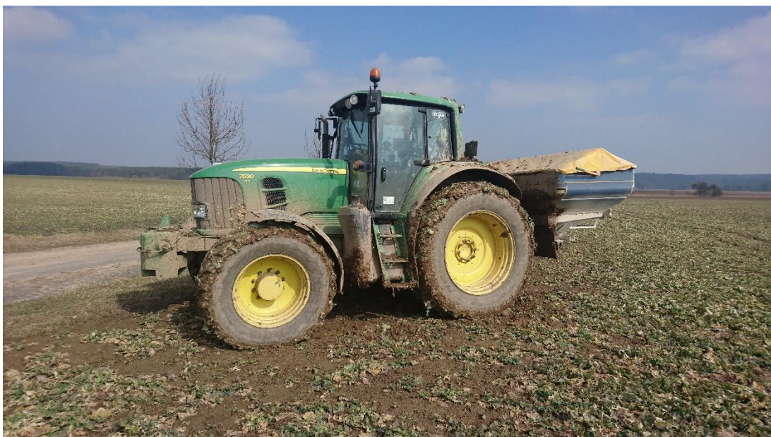
Příloha 1: John Deere 7530 Premium s rozmetadlem minerálních hnojiv Bogballe M2 Plus
