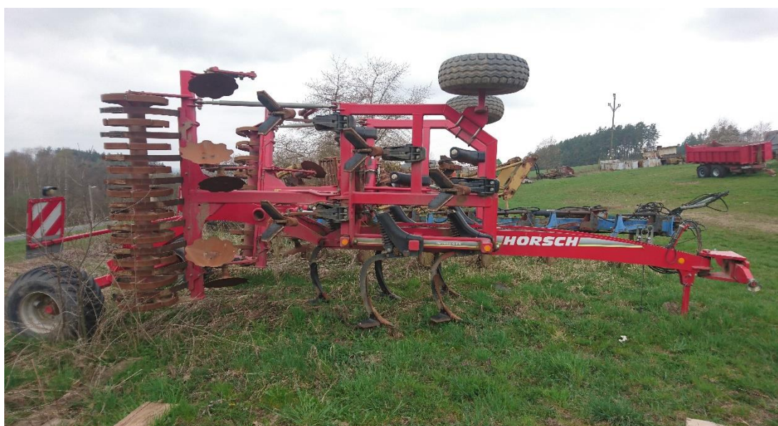
Obrázek 5: Radličkový kypřič Horsch Terrano 4FX
