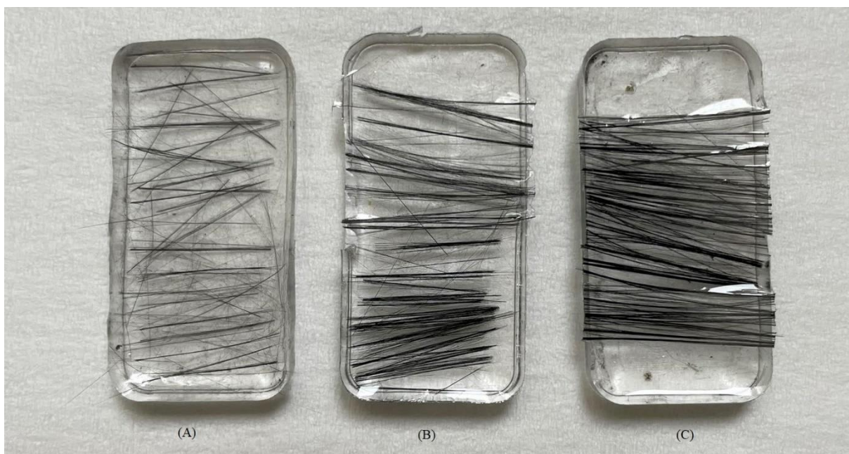
Obrázek 22: vzorky s přidávanými uhlíkovými vlákny; (A) 0,0015g, (B) 0,0030g, (C) 0,0045g
