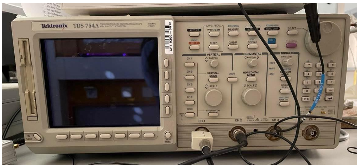
Obrázek 6: čtyř kanálový digitální osciloskop TDS 754A firmy Tektronix
