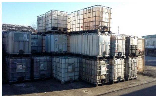
Obrázek 14 Skladování, stohování IBC kontejnerů
