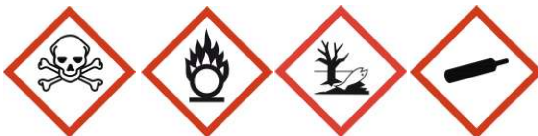
Obr. 1: Výstražné symboly nebezpečnosti chloru značí symboly toxický, oxidující, nebezpečný pro životní prostředí a plyny pod tlakem.[Zdroj: (19)]
