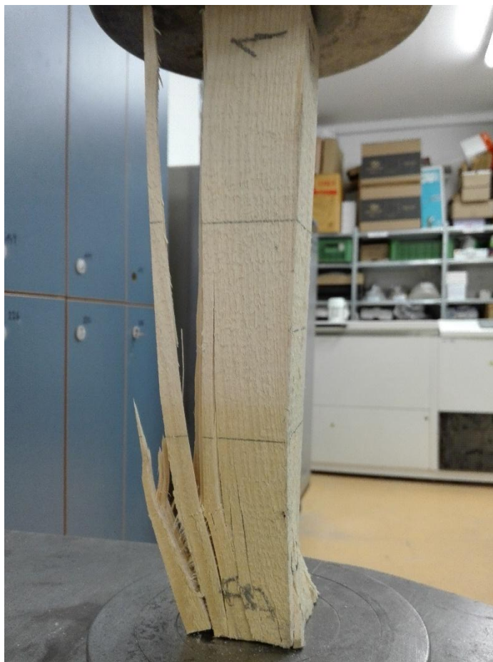
Obrázek 6.10: Deformace vzorku BC1 po dosažení F_{\max}
