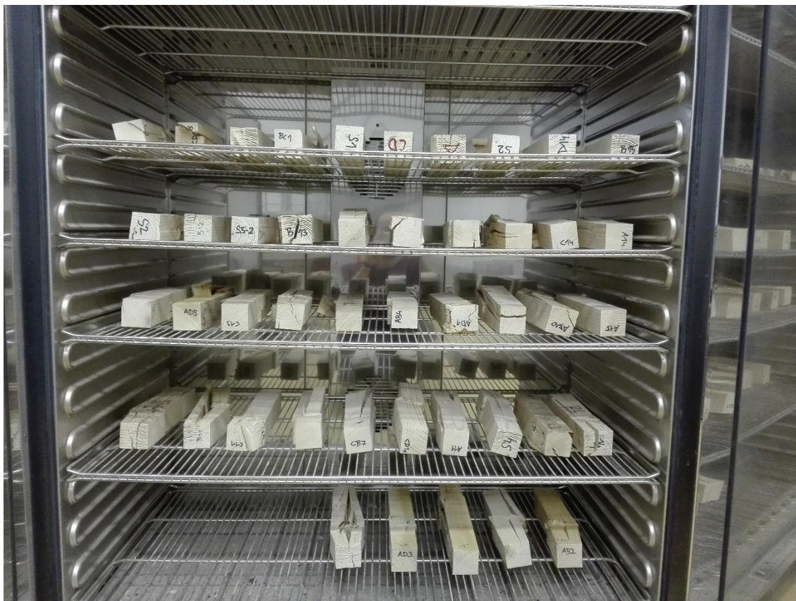
Obrázek 6.11: Porušené vzorky v sušičce
