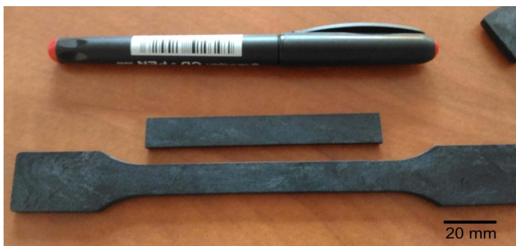
Obr. 3.1 Zkušební tělesa, nahoře pro zkoušku rázové houževnatost, dole pro zkoušku tahem
