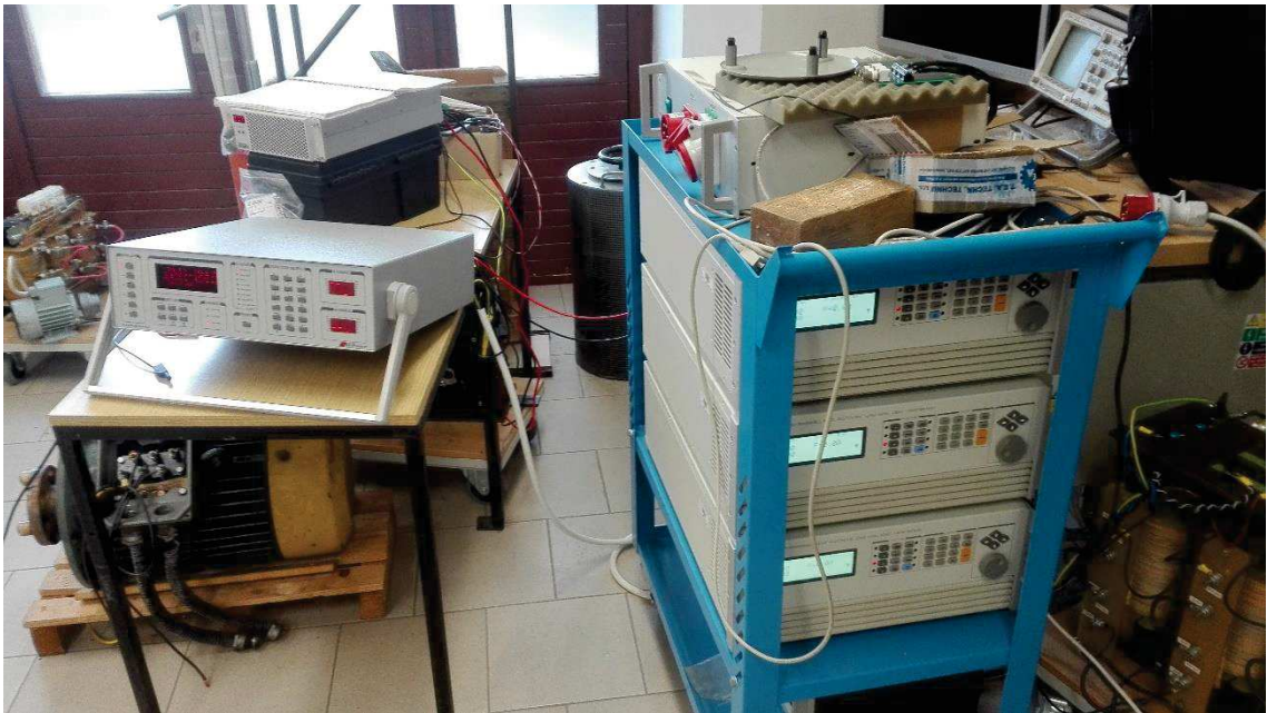
Obrázek 31 - Skutečné umístění měřicích přístrojů. V levé části obrázku vidíme síťový analyzátor (vepředu) a výkonový dobíjecí modul (vzadu). V pravé části se nacházejí programovatelné zátěže Chroma.
