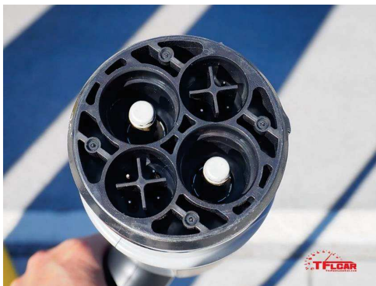
Obrázek 3 – Dobíjecí konektor typu CHAdeMO. Vidíme zde dva výkonové kolíky a osm komunikačních pinů (viz dále). Standardu CHAdeMO je často vytýkána velikost a nepraktičnost (používají doslova výraz „clunky“ – neohrabaný) dobíjecích „pistolí“. [6]
