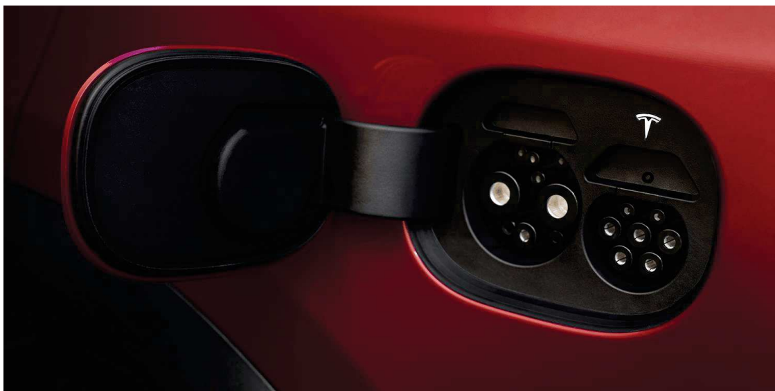
Obrázek 8 - Dobíjecí zásuvky na vozidle Tesla. Vlevo můžeme vidět dobíjecí standard GB/T 20234 DC verzi a vpravo dobíjecí standard GB/T 20234 AC verzi (téměř totožná jako evropský „Type 2“) [14]. Tesla umístěním standardu GB/T na svá vozidla reagovala na velký nárůst prodeje elektromobilů v Číně. Tyto GB/T zásuvky se na vozidle nacházejí za předním blatníkem, původní zásuvka Tesla Supercharger je pak umístěna na svém klasickém místě v zadní části vozu. [15]
