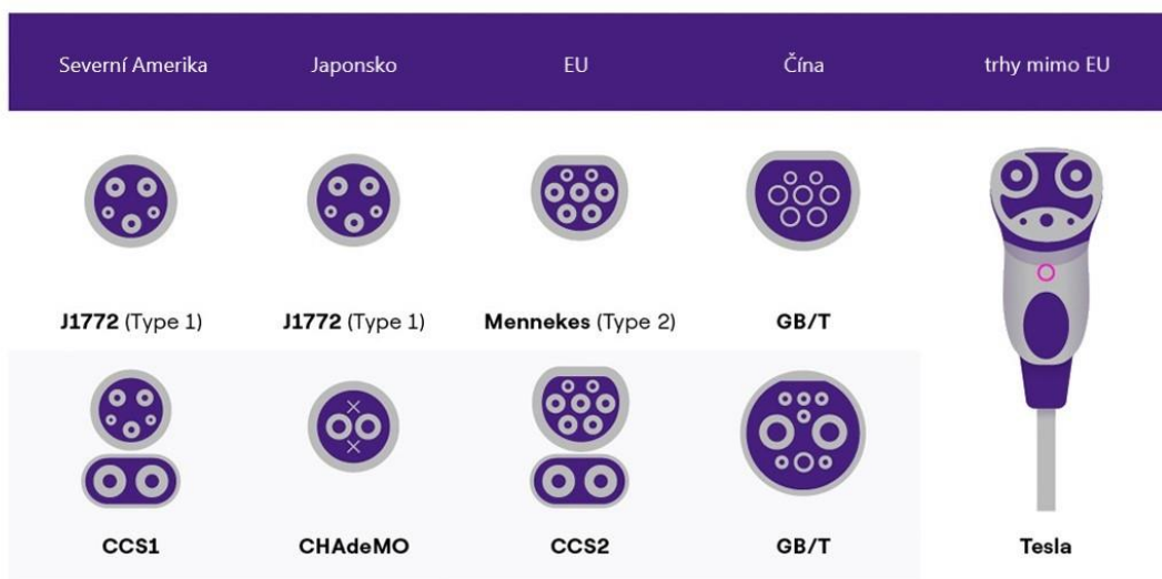
Obr. 31 Typy konektorů dle trhu a režimu nabíjení; upraveno dle [56]
