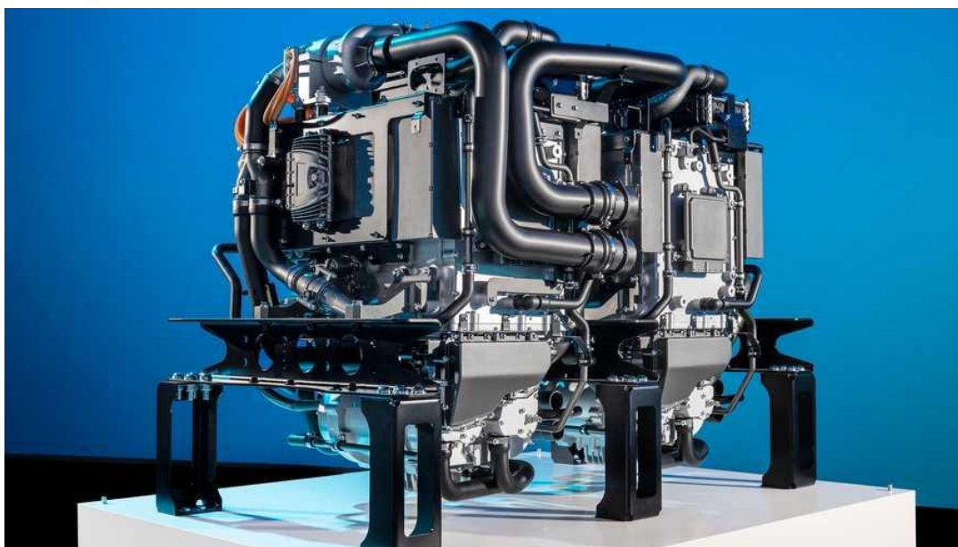
Obr. 44 Vodíkový systém vozu Mercedes-Benz Gen H 2 Truck [103]
