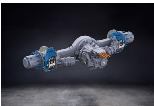
Obr. 8 Integrovaná elektrická náprava Meritor 14Xe [28]
