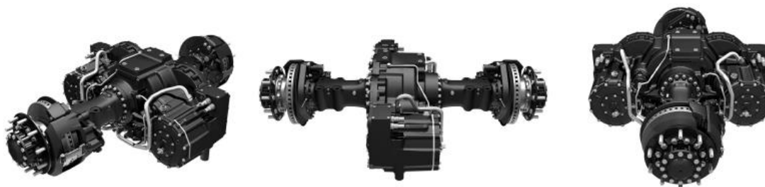
Obr. 10 Integrovaná elektrická náprava FPT Industrial eAX 375-R [29]
