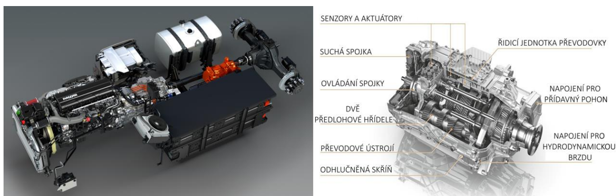
Obr. 30 Pohonné ústrojí vozu DAF CF a řez převodovkou ZF TraXon; upraveno dle [53,54]
