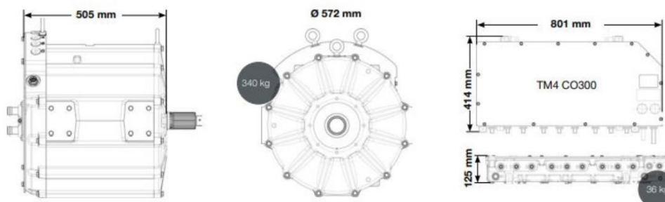
Obr. 4 Parametry elektrického stroje Dana TM4 Sumo HD; upraveno dle [18]
