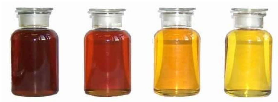
Obrázek 8 Vzorky odebraných olejů v průběhu regenerace, zleva od znečištěného postupně až po čistý
