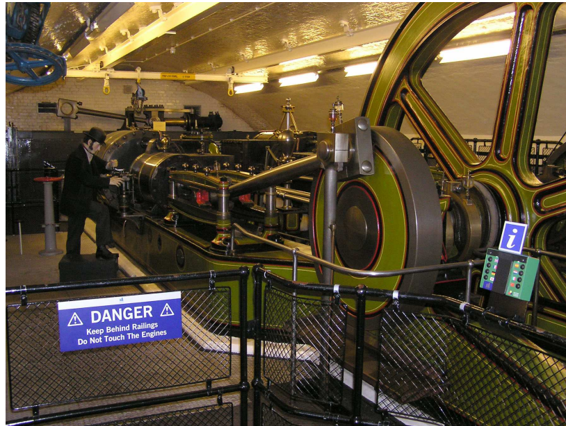
Obr.4-9 Stabilní parní stroj v Tower Bridge v Londýně. Jeden ze dvou strojů sloužících ke zvedání mostu[12].
