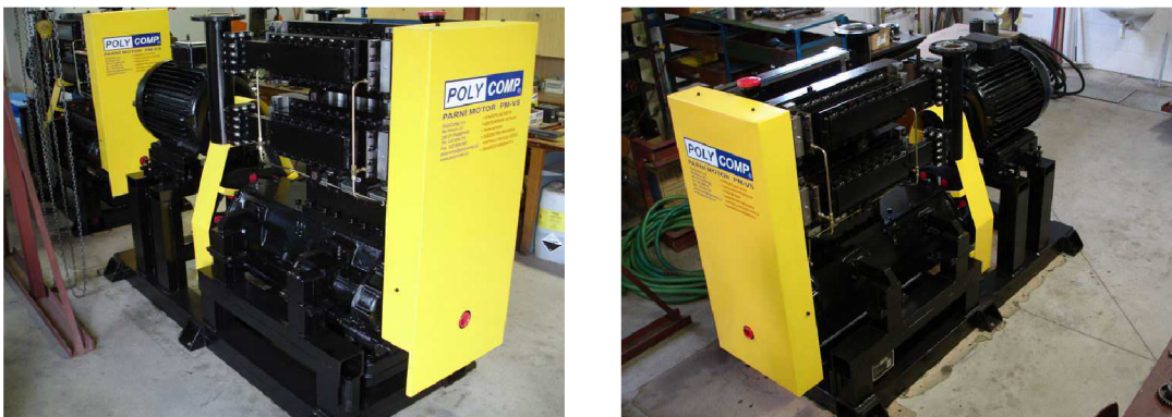
Obr. 5-2 Parní motor PM-VS pro výkon (10-75)kWe [26, 27]
