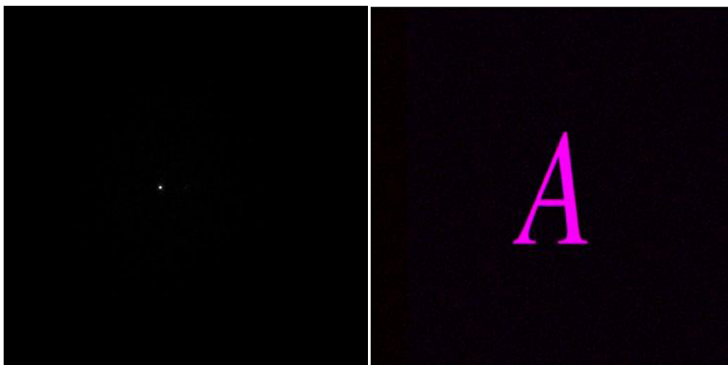
Obrázek 22: Obrázek vlevo znázorňuje fázovou korelaci identických vzájemně posunutých obrazů. Pozice maxima udává vektor posunutí. Obrázek vpravo je kombinací obrazu A a obrazu B posunutého o záporně vzatý nalezený vektor posunutí. Obrazu A byl přiřazen červený kanál RGB, obrazu B modrý kanál RGB. Fialová barva dokazuje shodu obou obrazů.
