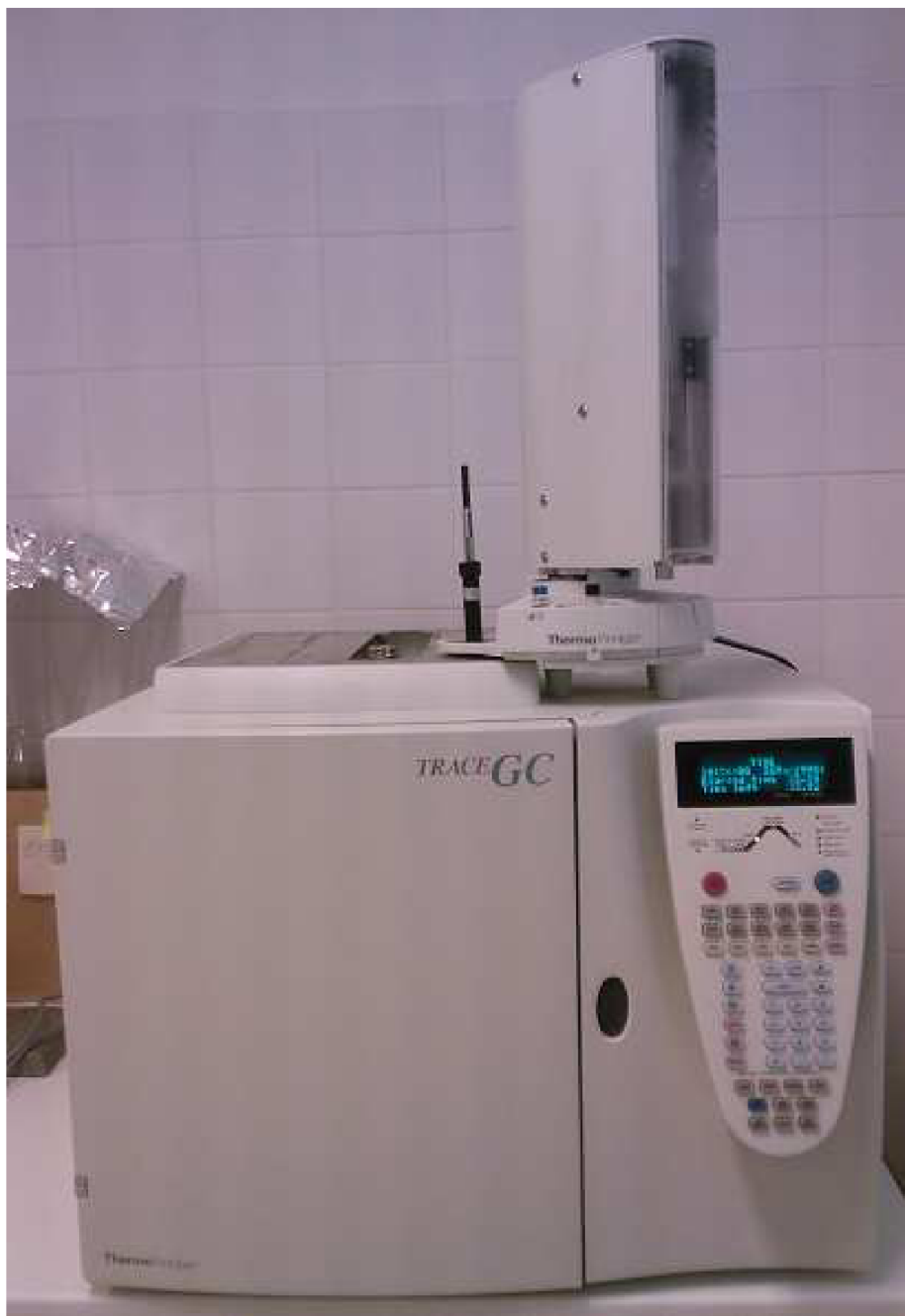
Obr. II. – Plynový chromatograf TRACE GC 2000 s plamenově ionizačním detektorem při probíhající desorpci analytů z SPME vlákna do GC
