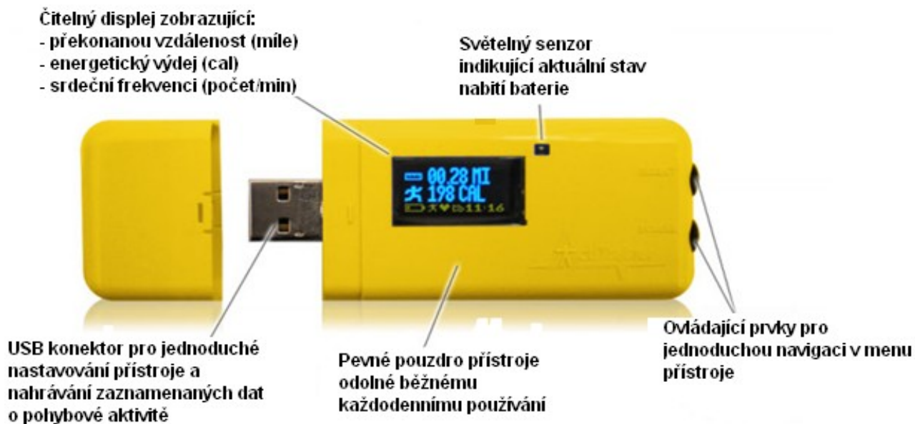
Obrázek 12. Multifunkční monitorovací přístroj ActiTrainer (akcelerometr + inklinometr + pedometr + snímač srdeční frekvence) s popisem ovládacích prvků
