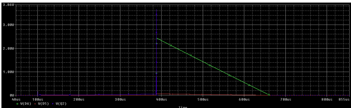
Obr. 24 Ztrátové výkony ve vysílacím obvodu cívky.
