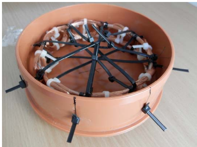
Obr. 50 Měřicí cívka před dotvarováním a zafixováním
