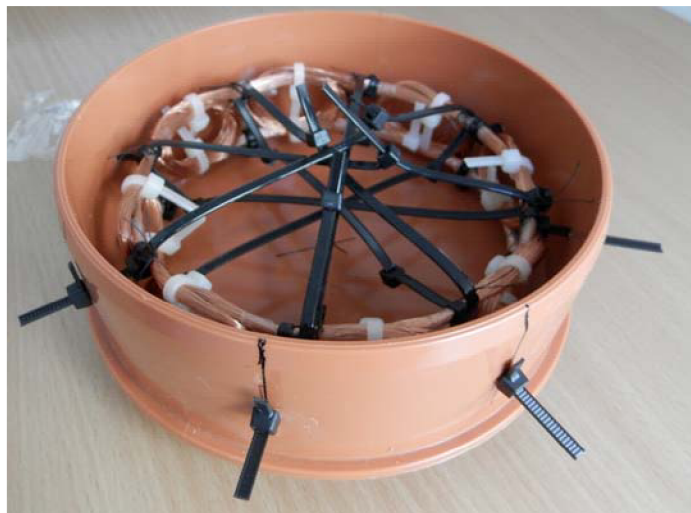
Obr. 50 Měřicí cívka před dotvarováním a zafixováním
