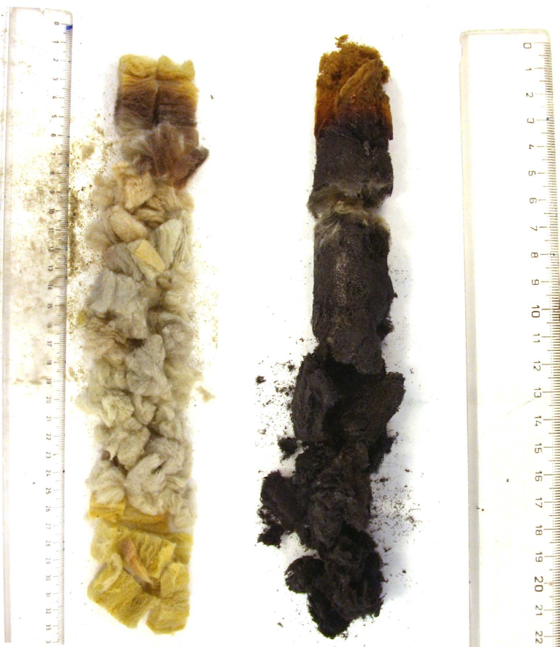
Obr.4.11: Vizuální vzhled vzorku A a B po analýze v aparatuře zahořívání.
