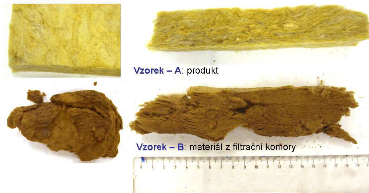
Obr.4.1: Fotografie vzorků materiálu převzatého k analýze ze Saint-Gobain Orsil.
