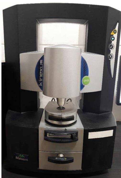
Obrázek 8: Dynamický smykový reometr (DSR)
