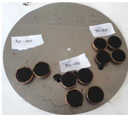
Obrázek 6: Seřiznuté odlitky asfaltového pojiva pro stanovení bodu měknutí
