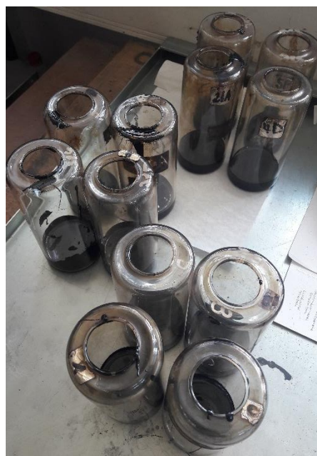
Obrázek 17: Připravené skleněné nádoby s asfaltovým pojivem
