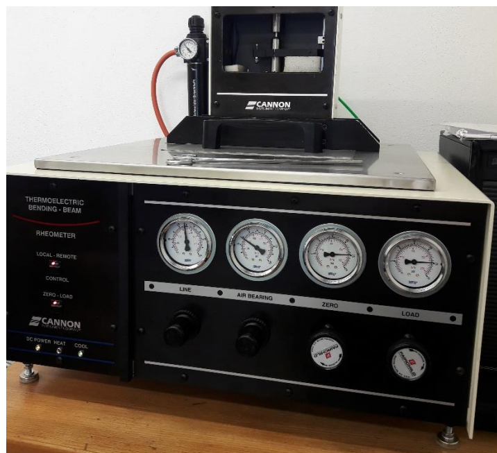
Obrázek 20: Průhybový trámečkový reometr (BBR)
