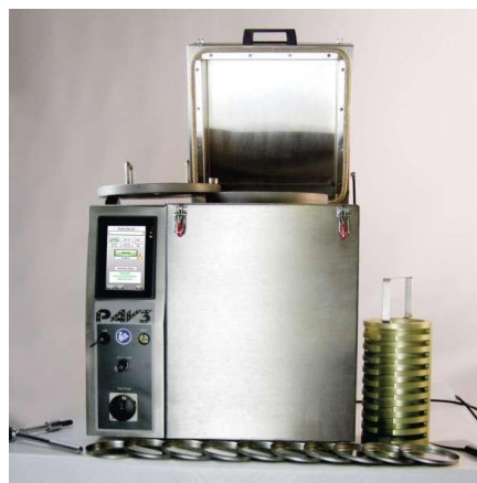
Obrázek 3: Přístroj pro měření PAV [23]
