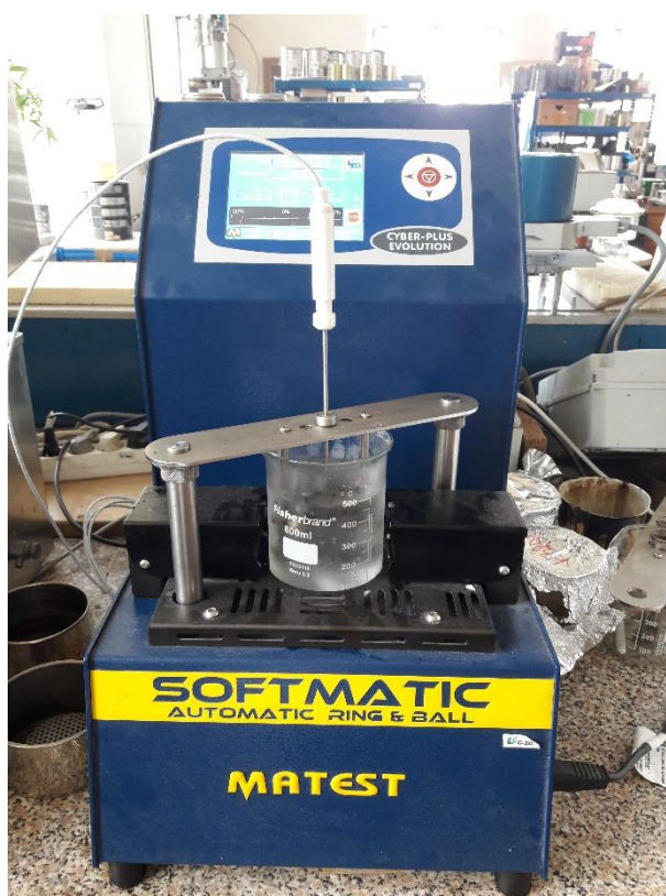
Obrázek 7: Probíhající zkouška Kroužek a kulička
