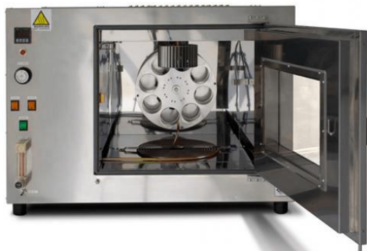
Obrázek 2: Přístroj pro měření RTFOT [22]
