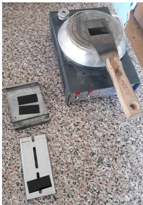
Obrázek 15: Příprava plíšků pro měření bodu lámavosti podle Fraasse
