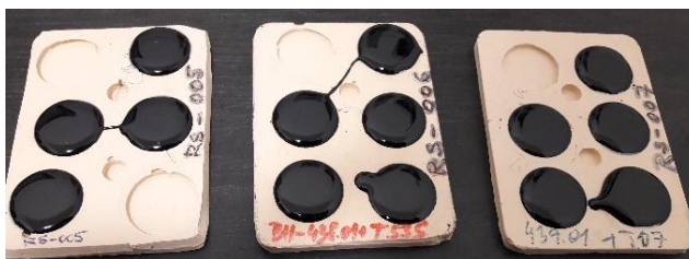
Obrázek 9: Vzorky pro měření v DSR
