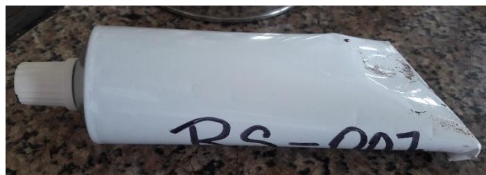
Obrázek 21: Tuba připravená pro stanovení skladovací stability
