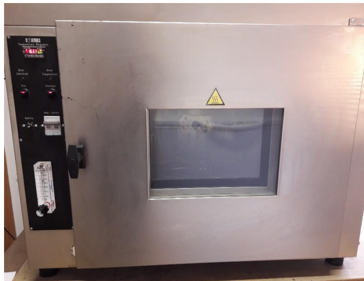
Obrázek 18: Sušárna používaná pro zkoušku RTFOT
