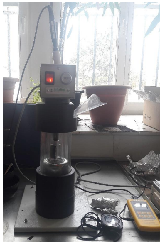
Obrázek 16: Příklad přístroje pro měření bodu lámavosti podle Fraasse
