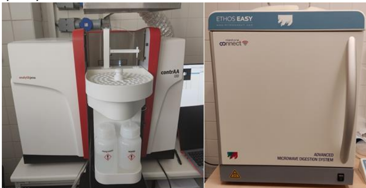
Obr. 6: Atomový absorpční spektrometr contrAA 800D Analytik Jena (vlevo) a mikrovlnné rozkladné zařízení ETHOS Easy (vpravo)
