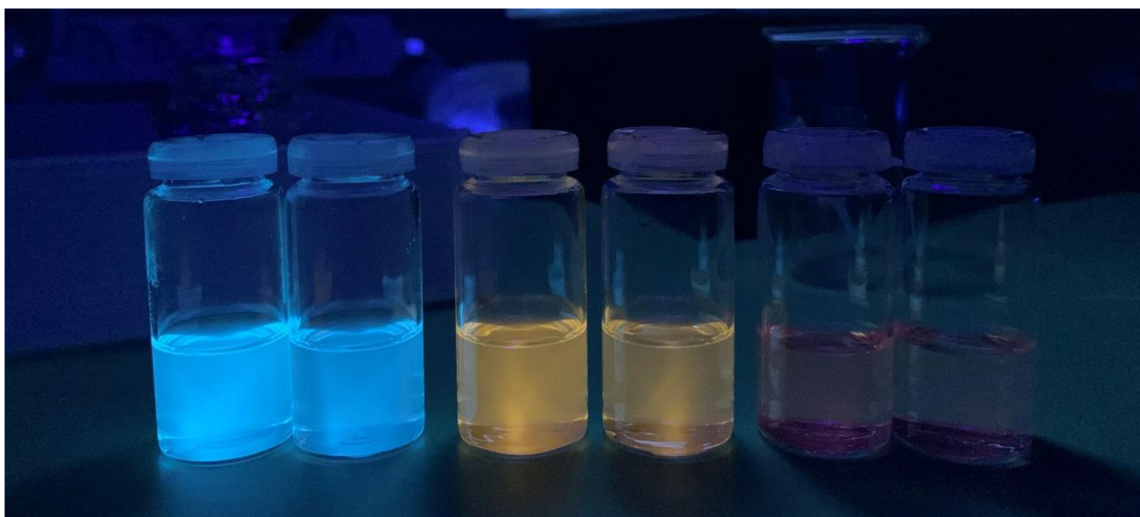
Obrázek 17 Charakteristické zbarvení fluorescence nanočástic vytvořených ze samotných látek, vlevo látka DPA-DPS-V, uprostřed DPA-DPS-V(COOMe) 2 , vpravo DPA-DPS-IOO
