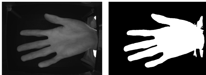
Obr. 5.5: Pôvodná snímka naľavo a výsledok po detekcii kontúr napravo.
