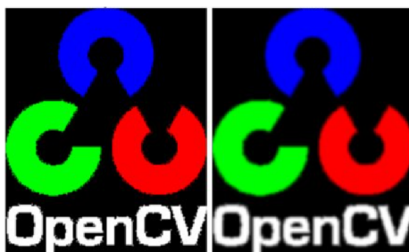
Obr. 4.2: Naľavo je pôvodný obrázok a napravo výsledok po gaussovskom rozmazaní [17].
