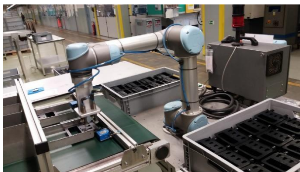
Obrázek 17: Jednoduchý robot pro sortaci produktů z dopravníku
