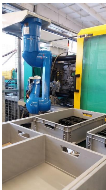
Obrázek 18: Šestiosý robot pro vyjímání plastových výrobků z formy a ukládání do balných jednotek
