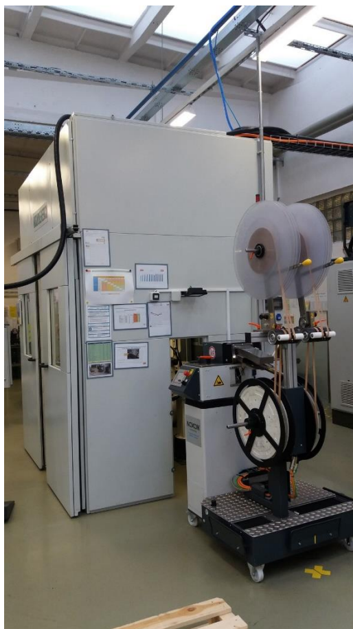
Obrázek 26: Nový stroj Bruderer s navíječem Noxon Zdroj: Vlastní zpracování
