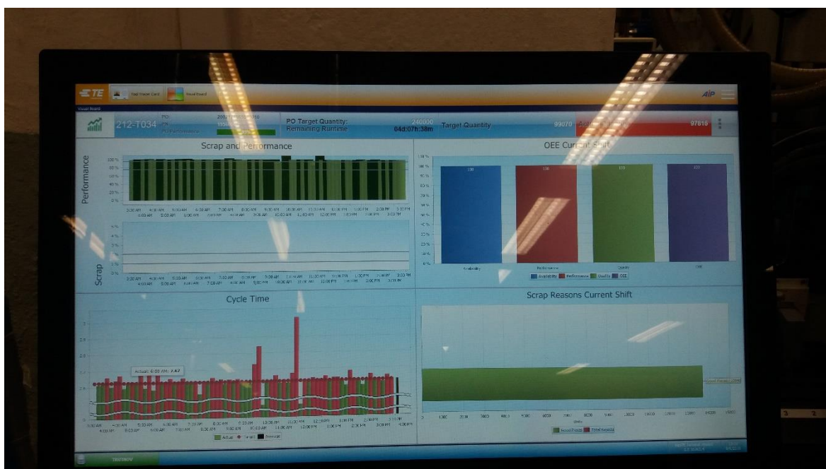
Obrázek 16: Zobrazený výkon pracoviště pomocí samostatného Hydra terminálu
