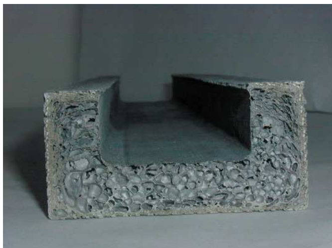
Obrázek 2.6: Zaválcovaný plech v hliníkové pěně
