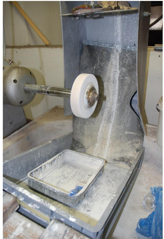
Kuličkový stroj, opatřený kotoučem pro proleštění rytiny.
