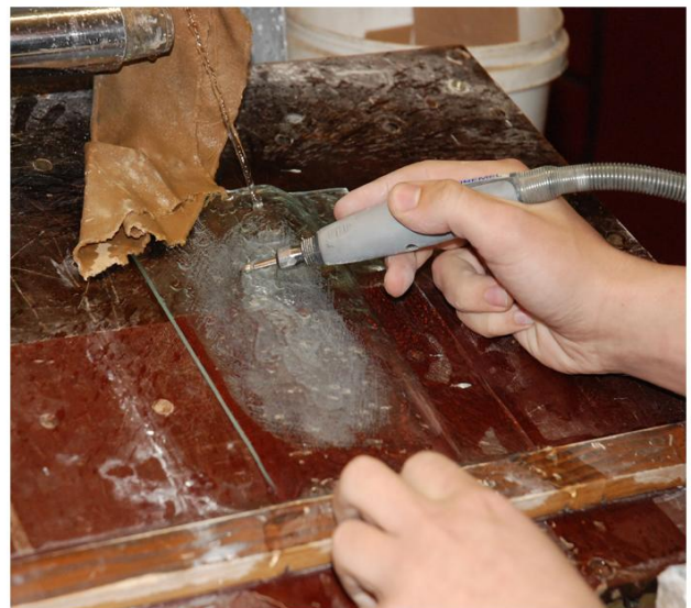
Vlastní proces rytí diamantovými stopkami
