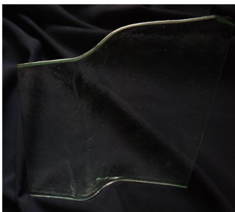
Výroba „stély”, detail skleněné desky po „lehnutí”.
