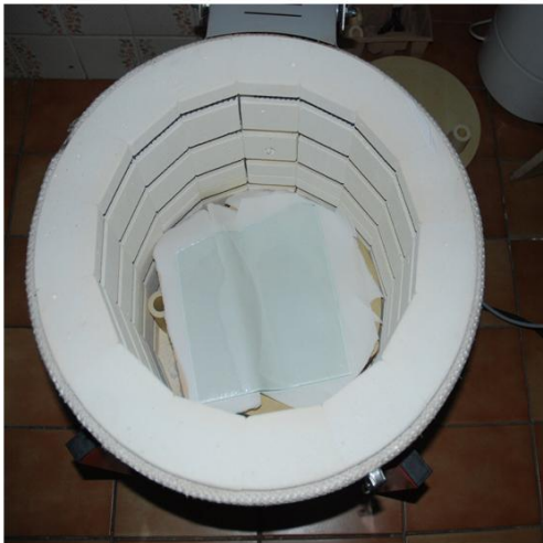
Výroba „stély”, skleněná deska v peci, po „lehnutí”.
