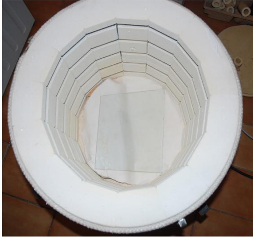
Výroba „stély”, skleněná deska v peci připravená na „lehnutí” podle formy.
