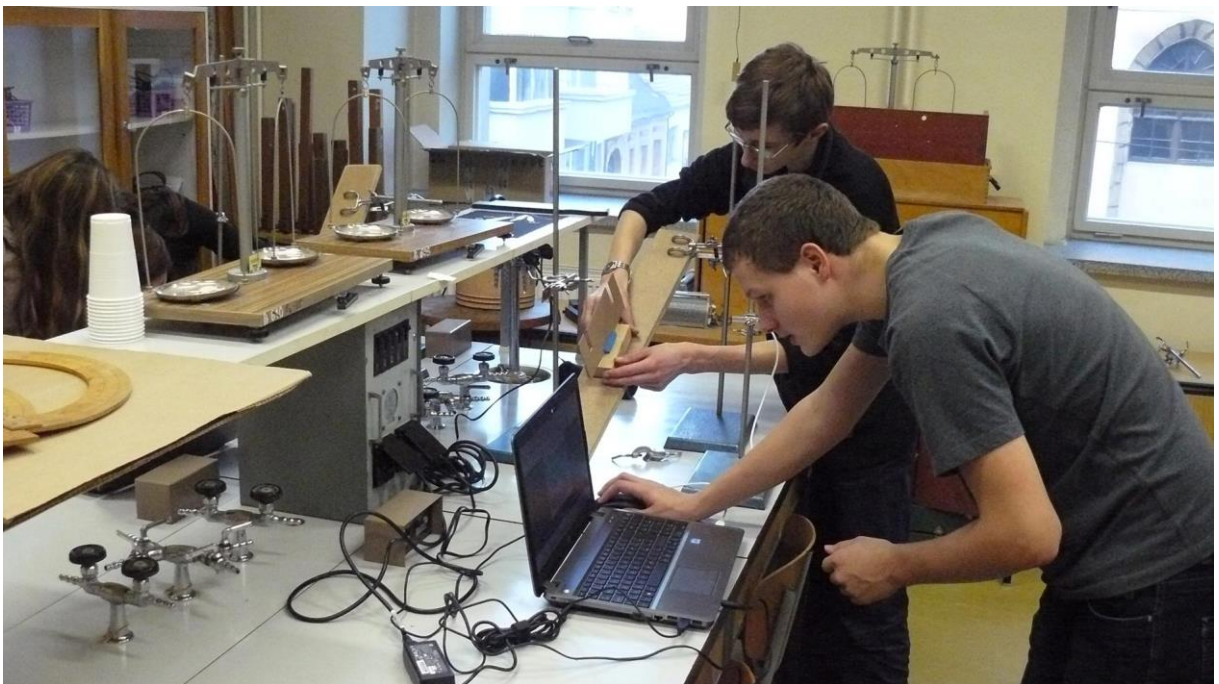
Obrázek 12 – realizace měření součinitele smykového tření ze zrychlení na nakloněné rovině
