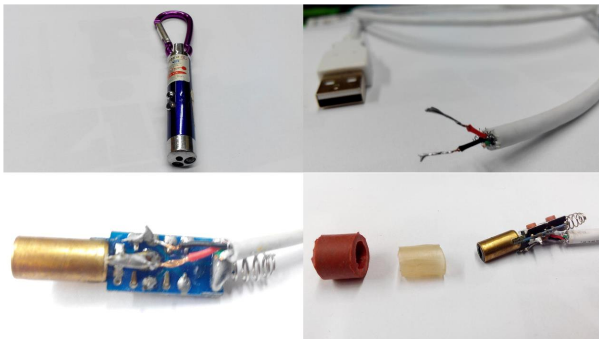
Obrázek 6.5.1 Úprava laseru pro napájení z USB portu počítače
