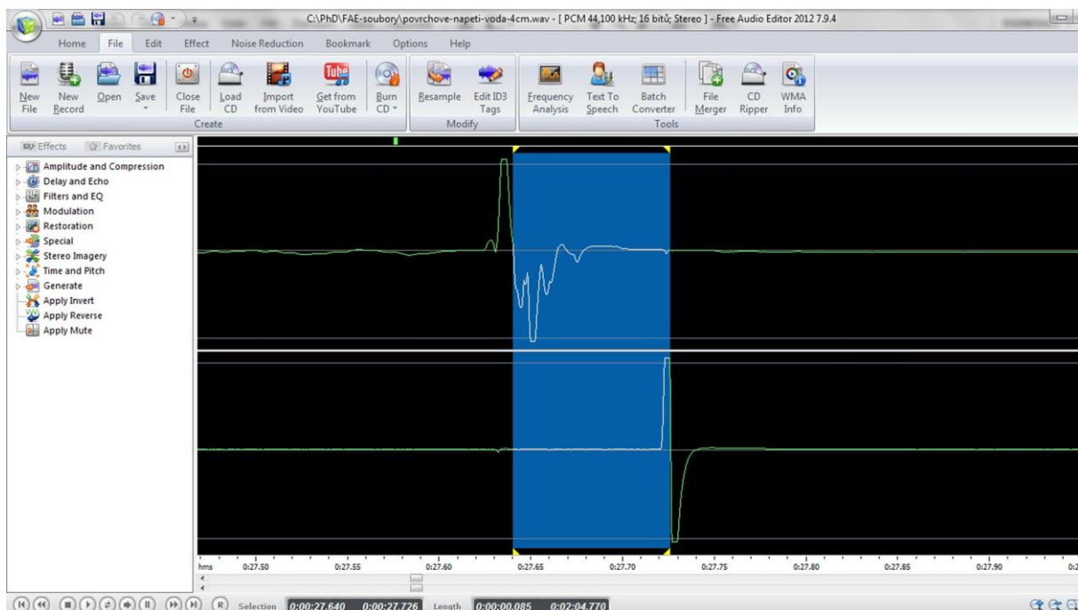
Obr. 2.3.2 Oscilogram experimentu – Měření povrchového napětí kapaliny metodou maximální kapky – zobrazení signálu kanálu L (nahore) a R (dole)
