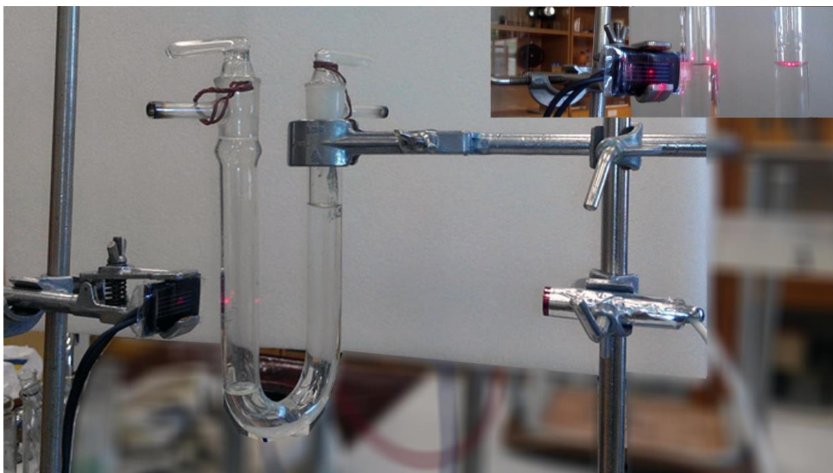
Obrázek 2.6.2 Uspořádání experimentu – Měření logaritmického dekrementu útlumu kmitů v U-trubici
