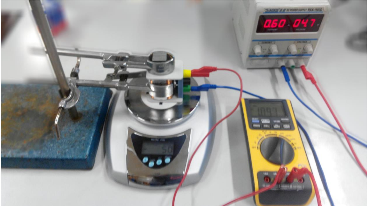
Obrázek 3.1.1 Uspořádání experimentu – Měření magnetické indukce elektromagnetu
