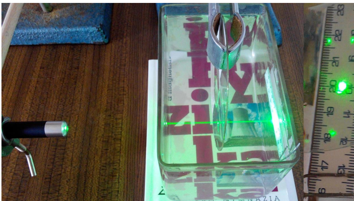
Obrázek 4.2.1 Uspořádání experimentu – Měření indexu lomu kapaliny pomocí CD disku – boční pohled
