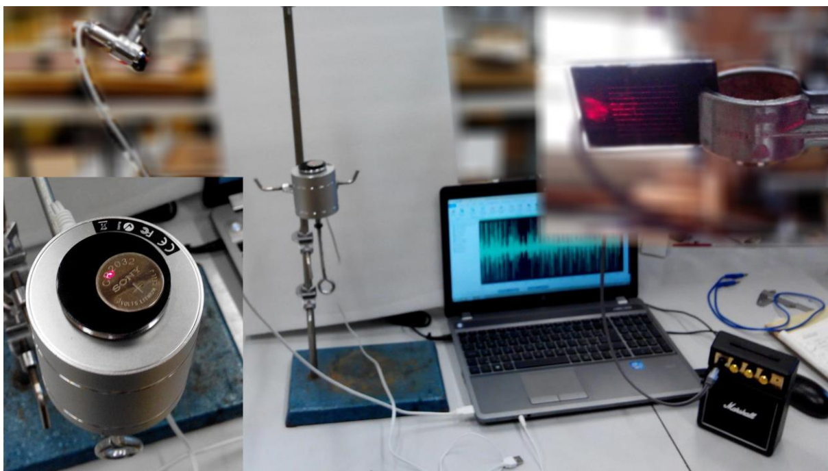
Obrázek 3.6.1 Uspořádání experimentu – Přenos zvuku laserovým paprskem
