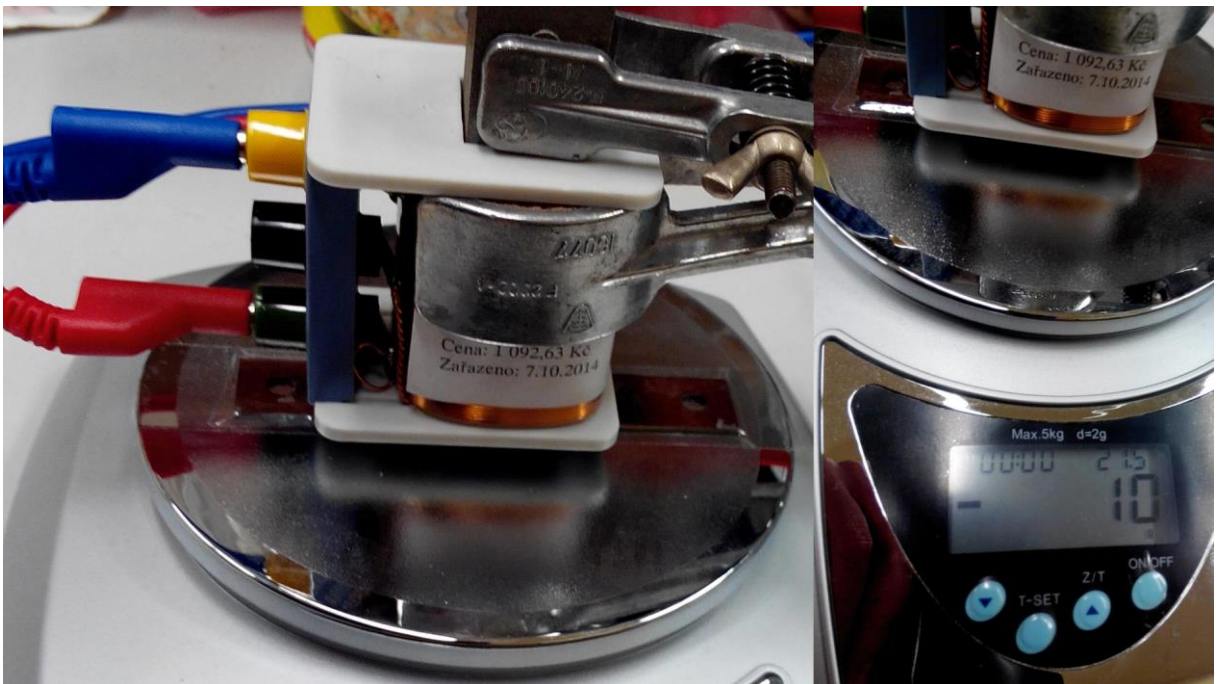
Obrázek 4.1.2 Uspořádání experimentu – Měření rychlosti světla z vakuových konstant – měření permeability
