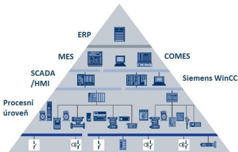
Obr. 1: Úrovně automatizačních zařízení v podniku [25]
