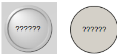
Obr. 35: Vlevo - kulaté tlačítko systému WinCC, vpravo - tlačítko systému COMES
