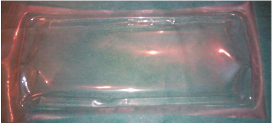
Obrázek 17: Nastavení 110 °C – nevyhovující odlupovatelnost
