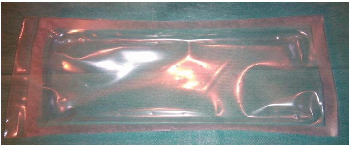
Obrázek 32: Nastavení 105 °C – vyhovující odlupovatelnost
