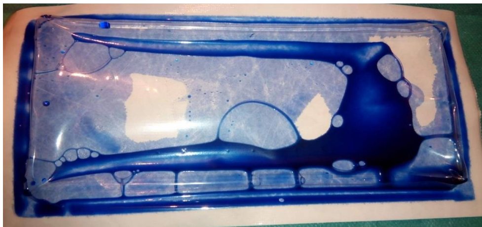
Obrázek 21: Nastavení 115 °C – vyhovující prolévání toluidinovou modří
