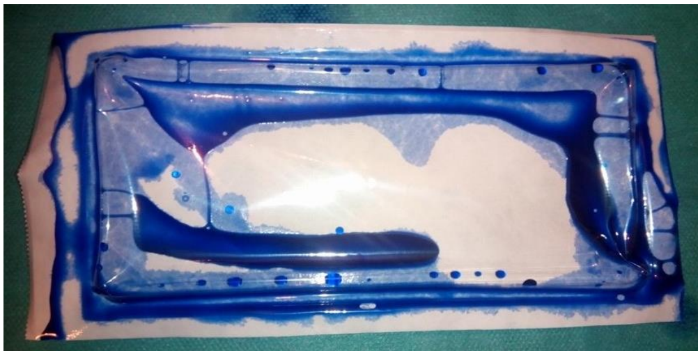
Obrázek 16: Nastavení 105 °C – nevyhovující prolévání toluidinovou modří
