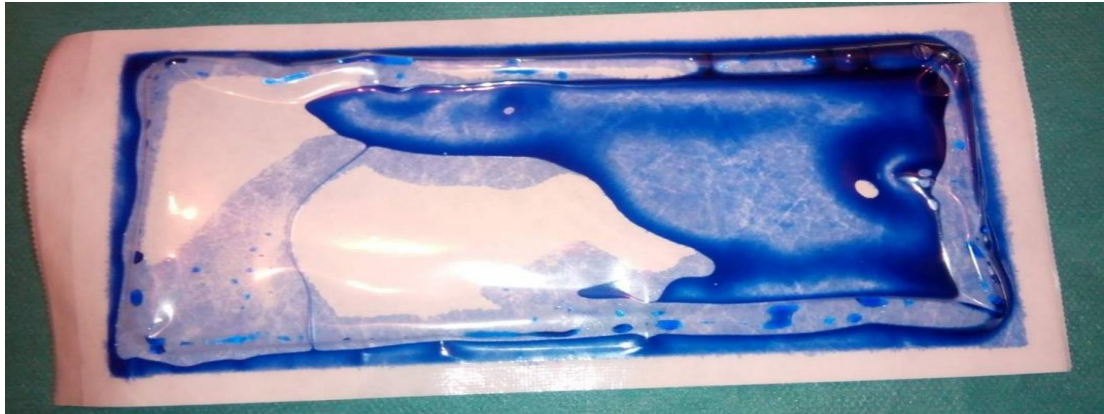
Obrázek 33: Nastavení 105 °C – vyhovující prolévání toluidinovou modří
