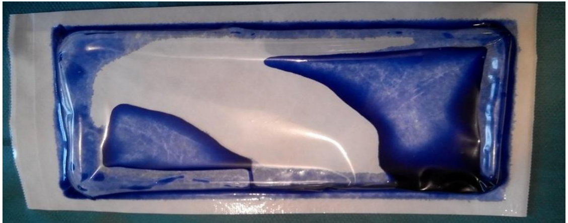
Obrázek 27: Nastavení 95 °C – vyhovující prolévání toluidinovou modří
