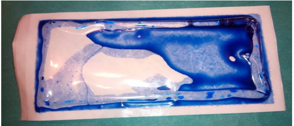
Obrázek 30: Nastavení 100 °C – vyhovující prolévání toluidinovou modří
