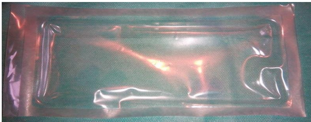
Obrázek 26: Nastavení 95 °C – nevyhovující odlupovatelnost
