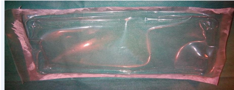
Obrázek 20: Nastavení 115 °C – nevyhovující odlupovatelnost kód vady D6
