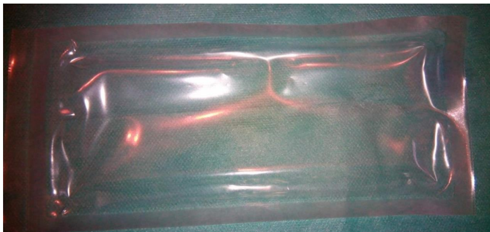
Obrázek 23: Nastavení 90 °C – nevyhovující odlupovatelnost
