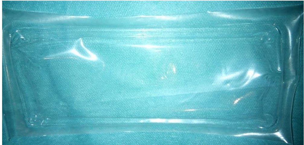
Obrázek 15: Nastavení 105 °C – nevyhovující odlupovatelnost
