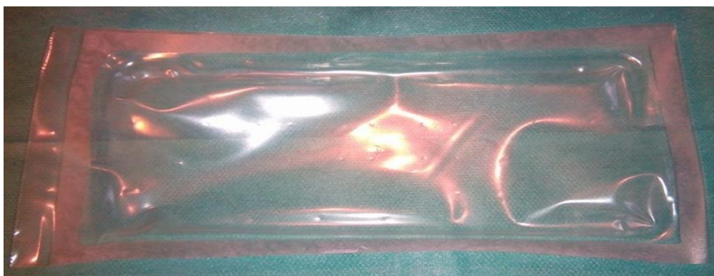
Obrázek 29: Nastavení 100 °C – vyhovující odlupovatelnost
