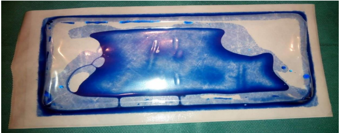
Obrázek 39: Nastavení 115 °C – vyhovující prolévání toluidinovou modří
