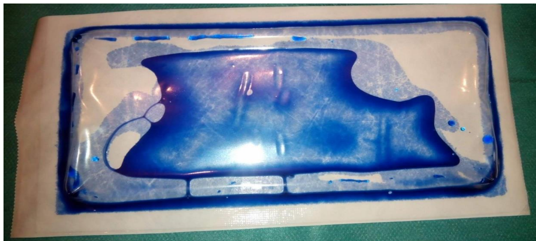
Obrázek 36: Nastavení 110 °C – vyhovující prolévání toluidinovou modří
