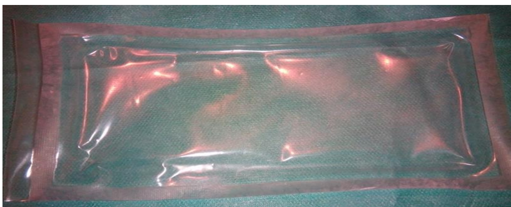
Obrázek 35: Nastavení 110 °C – vyhovující odlupovatelnost
