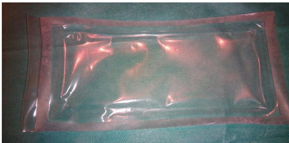
Obrázek 38: Nastavení 115 °C – vyhovující odlupovatelnost
