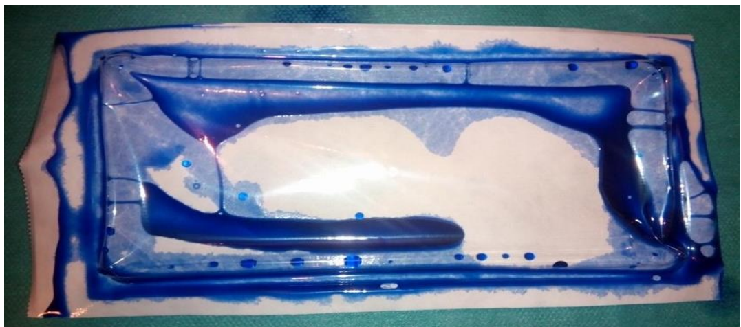
Obrázek 18: Nastavení 110 °C – nevyhovující prolévání toluidinovou modří
