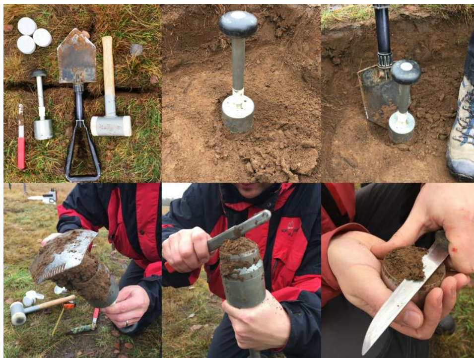
Obrázek 5.3: Odběr neporušených vzorků
