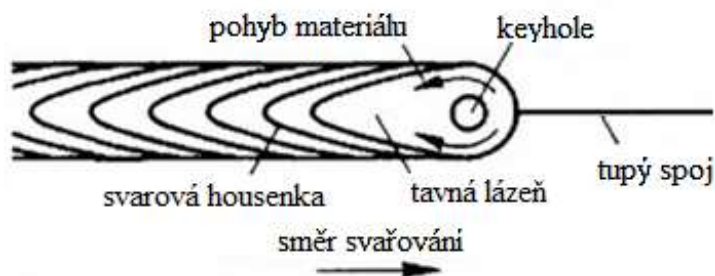
Obr. 7 Půdorys s označením oblastí svařování metodou keyhole [23]
