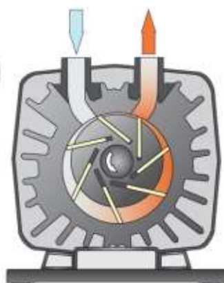
Obr. 15 Princip rotační olejové vývěvy [4]
