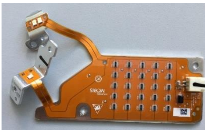
Obrázek 19 Flex board (Flexibilní deska) (Hyundai Tuscon - Mobis)
