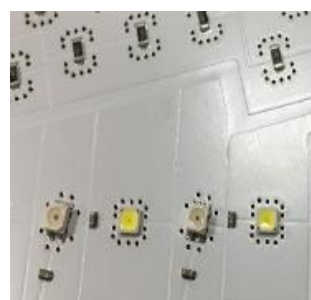
Obrázek 13 Prokovy v okolí tepelných zdrojů (Citroën DS7 zadní svítidla - AL)
