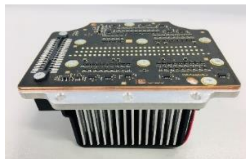
Obrázek 17 PCBA – CU IMS + chladič Matrix technologie
