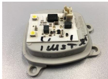
Obrázek 18 Keramické PCB (ZKW)
