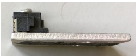
Obrázek 14 PCBA – ALU IMS Samsung C series (Hyundai Tuscon - Mobis)
