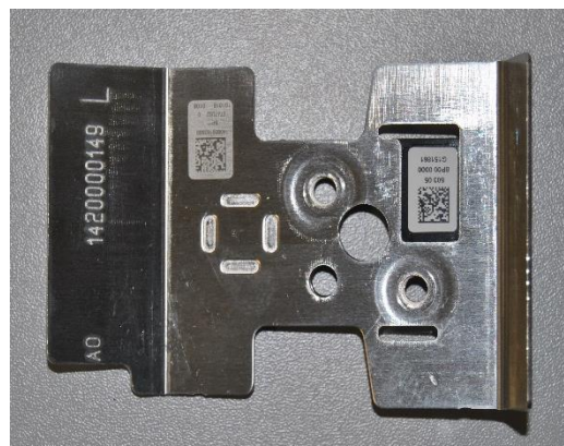
Obrázek 24 Plechový chladič ohýbaný Audi E-Tron (AL)
