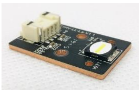
Obrázek 16 PCBA – CU IMS (Kamaz 54901 - Atvose)
