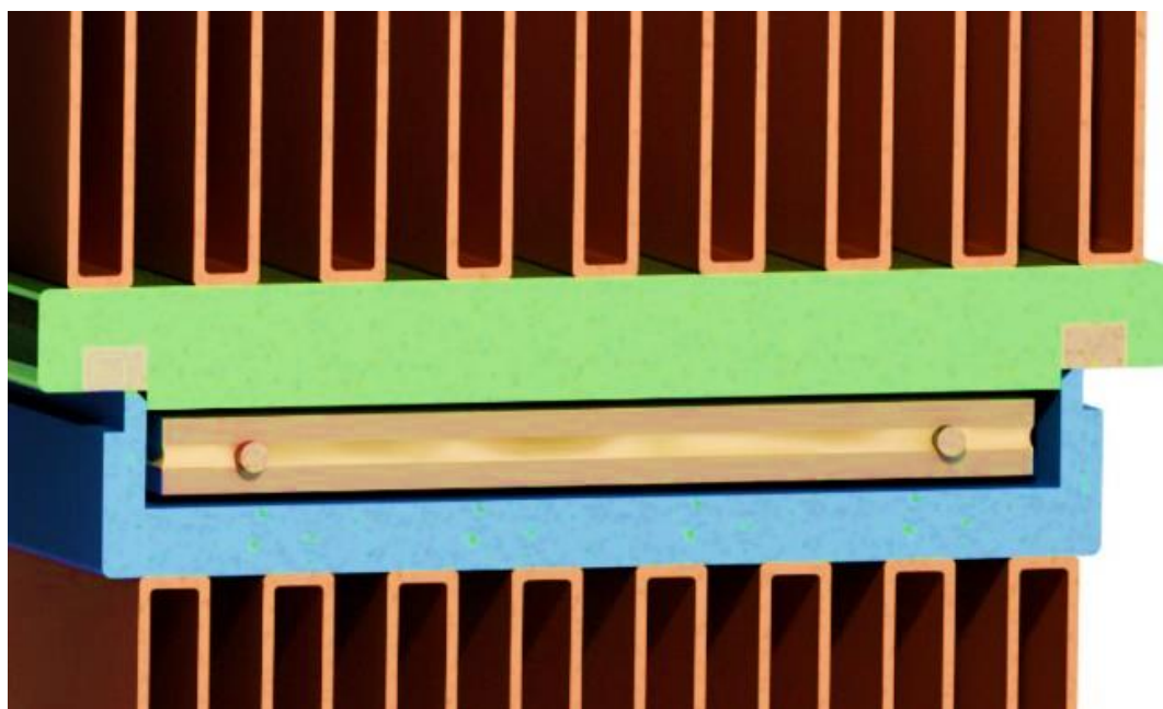
Obrázek 3p. Řez chladičí soustavou
