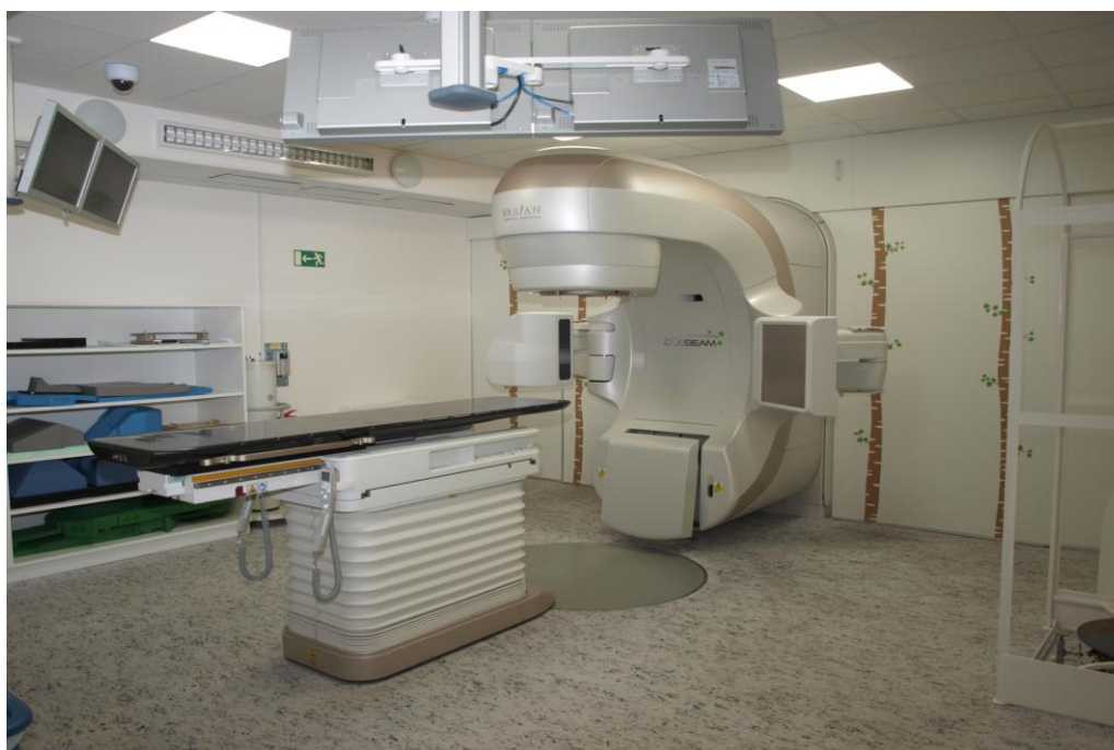
Obr. č. 1: Lineární urychlovač TRUEBEAM od firmy Varian na onkologickém oddělení Nemocnice České Budějovice a.s.
