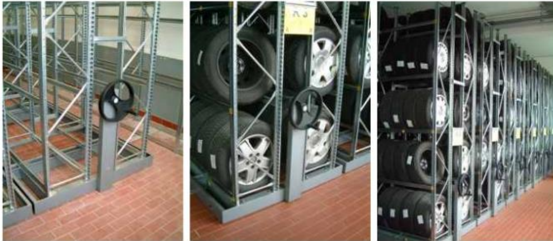
Obr. 19 Pojízdný policový regál na pneumatiky [23]
