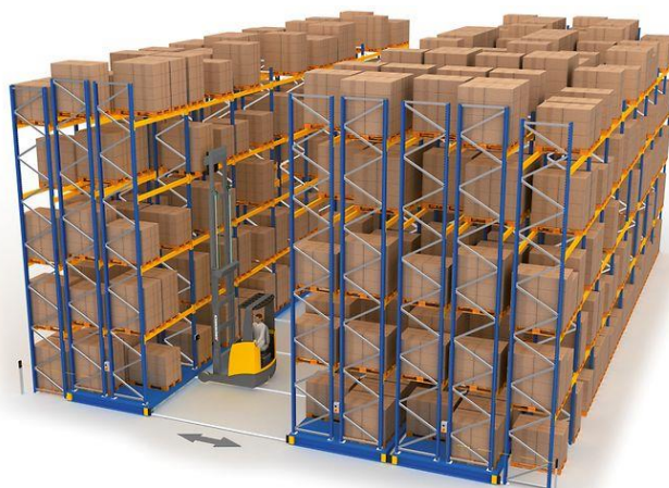
Obr. 11 Mobilní (pojezdový) regál [17]
