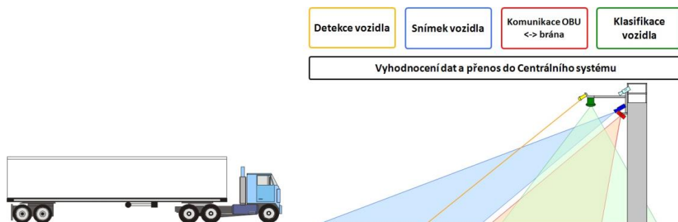
Obr.19 Funkce mikrovlnného systému
