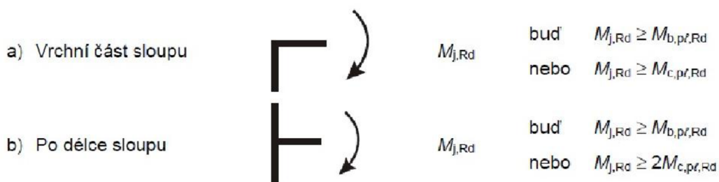
Obrázek 28. Styčník s plnou únosností (obr. 5.5 z [3])
