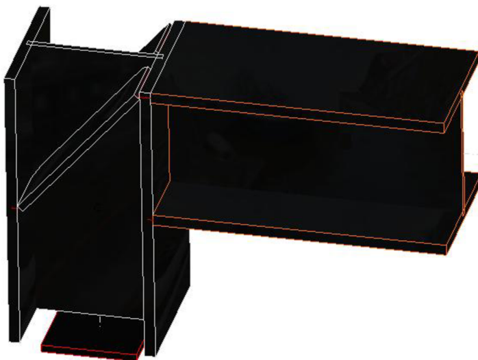
Obrázek 53. Model svařovaného styčnicku s diagonální výztuhou
