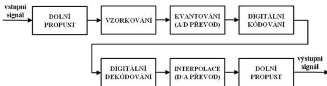
Obrázek 7 Blokové schéma digitalizace a rekonstrukce původního signálu – převzato z [16]
