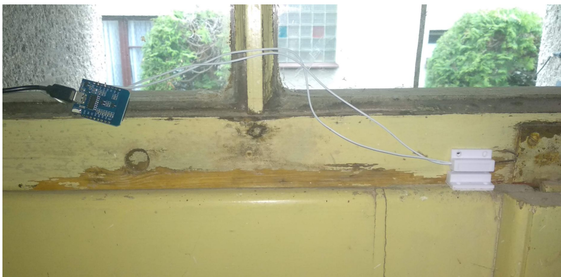
Obrázek 4.3: Modul pro detekci otevření a zavření dveří složený z desky WeMos D1 mini Lite (vlevo) s připojeným magnetickým čidlem (vpravo). Fotka je z reálného nasazení, modul je upevněný na domovních dveřích.
