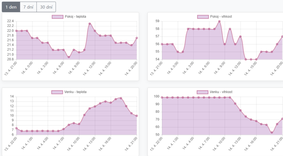
Obrázek 4.11: Obrazovka obsahující grafy s historií teploty a relativní vzdušné vlhkosti v pokojích a venku. Na výběr je ze tří časových období.
