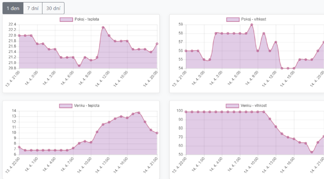
Obrázek 4.11: Obrazovka obsahující grafy s historií teploty a relativní vzdušné vlhkosti v pokoji a venku. Na výběr je ze tří časových období.
