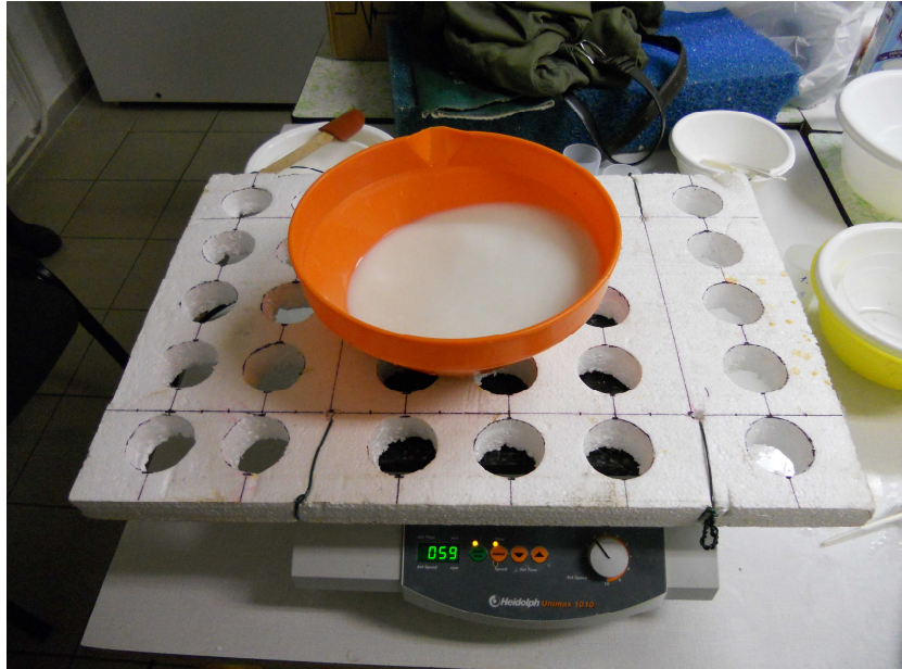
Obr. č.10. Odlepkování jiker směsí mastku a sušeného mléka a jejich míchání pomocí laboratorní třepačky
