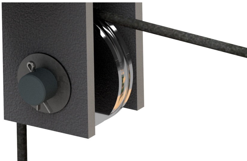
Obrázek 3.15: Pojištění čepu závlačkou
