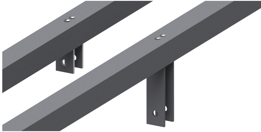
Obrázek 3.12: Detail uchycení držáků na kladky
