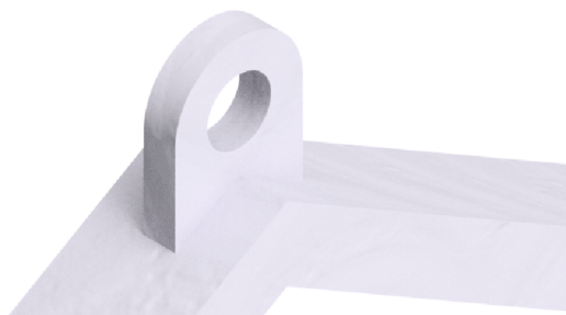
Obrázek 3.10: Detail záchytného bodů pro lano
