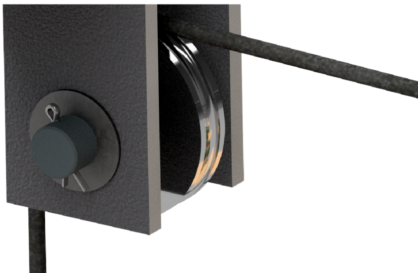
Obrázek 3.15: Pojištění čepu závlačkou
