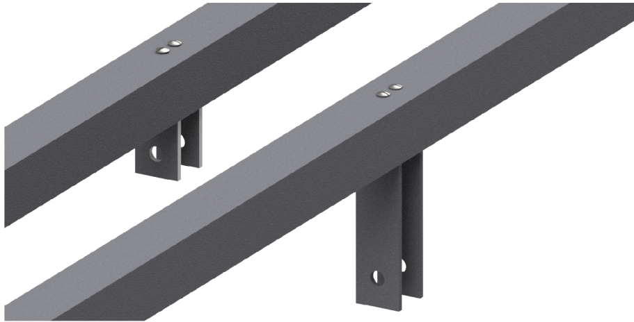
Obrázek 3.12: Detail uchycení držáků na kladky
