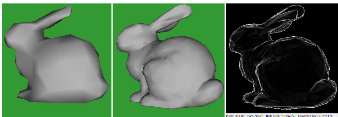
Obrázok 4.5: Zľava: Simplifikovaný model, jeho originál a výsledok hranového porovnania. Čím je farba viac biela, tým je v danom pixely väčšia chyba medzi hranami.
