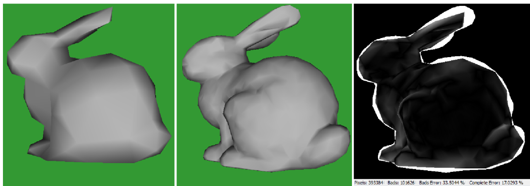
Obrázok 4.4: Zľava: Simplifikovaný model, jeho originál a výsledok obrazového porovnania. Čím je farba viac biela, tým je v danom pixely väčšia chyba.
