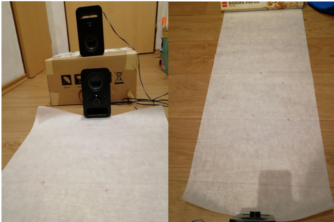
Obr. 40 Interference – nastavení reproduktorů a zakreslená zjištěná maxima
