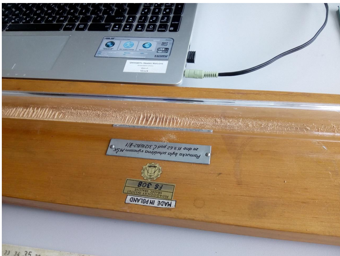
Obr. 34 Detail – zviditelněná stojatá vlna
