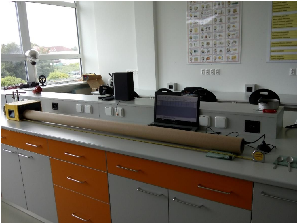
Obr. 26 Měření rychlosti zvuku jedním mikrofonom
