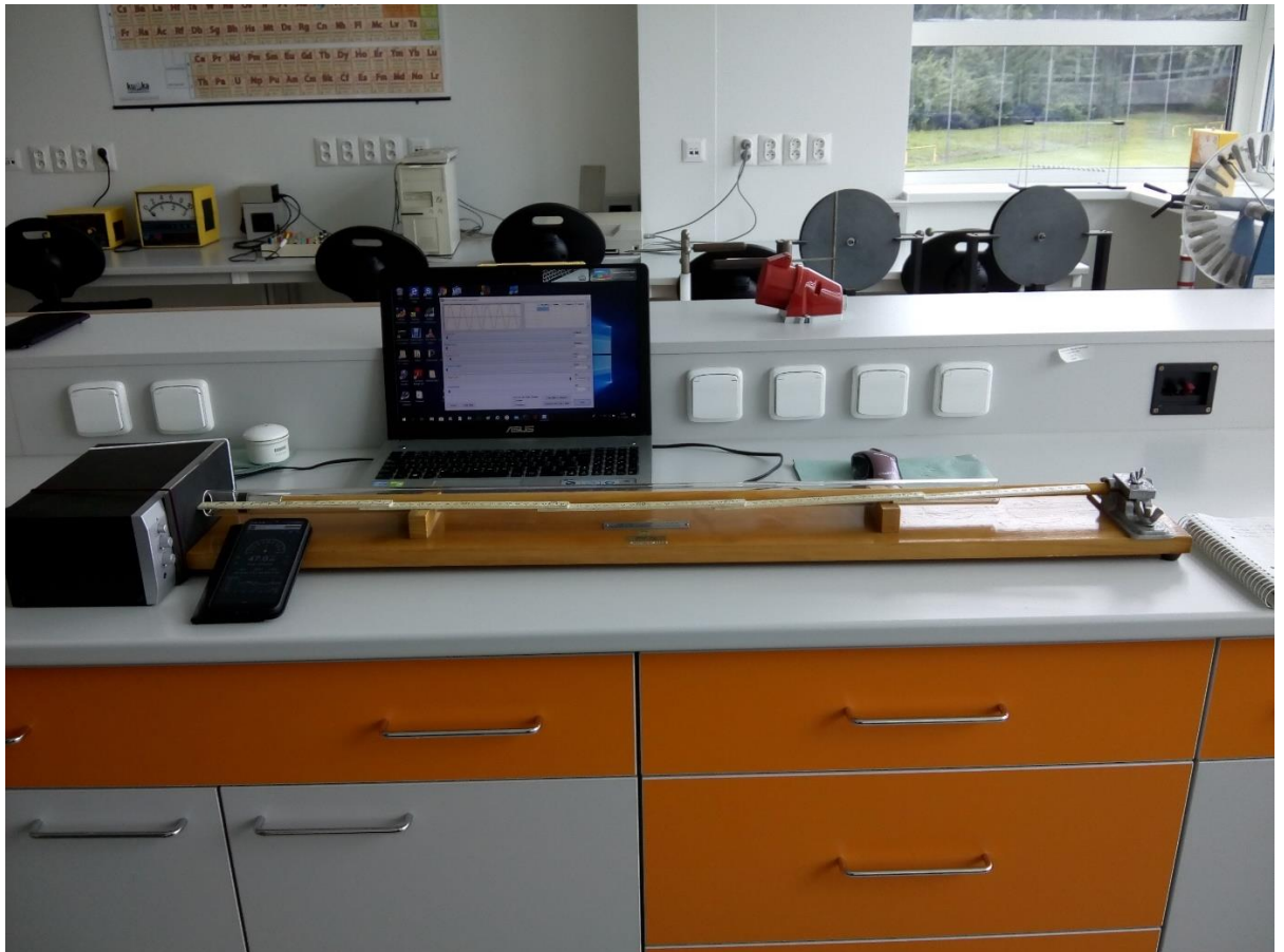
Obr. 31 Kundtova trubice s tónovým generátorem
