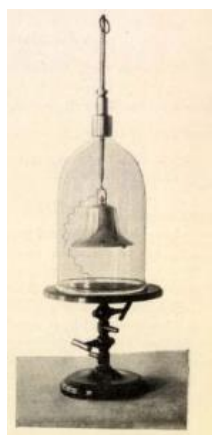
Obr. 14 Zvuk se nešíří ve vakuu
