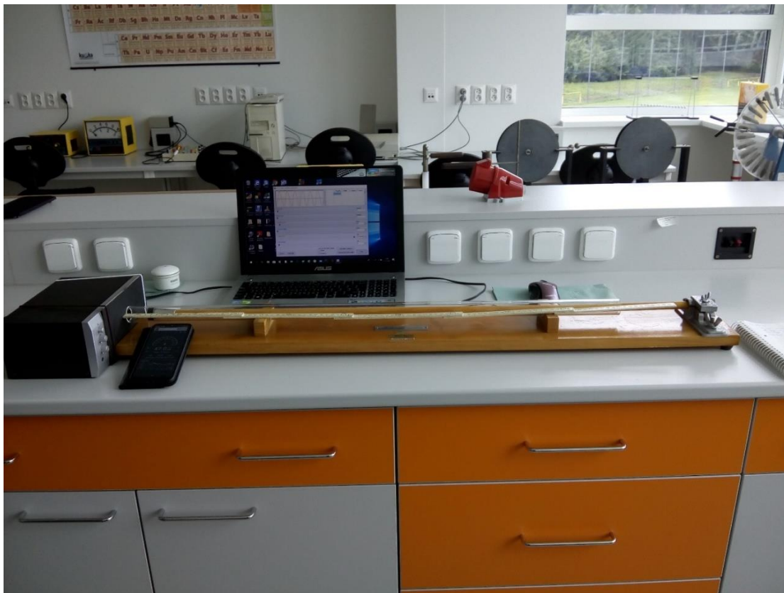
Obr. č.1 – Kundtova trubice s tónovým generátorem
