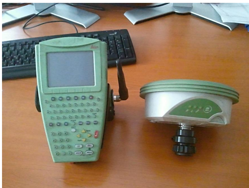
Obrázek 16 Aparatura Leica GPS typu RX1250XC s nasazovací anténou ATX 1230 CG (Zdroj: Vlastní fotografie)
