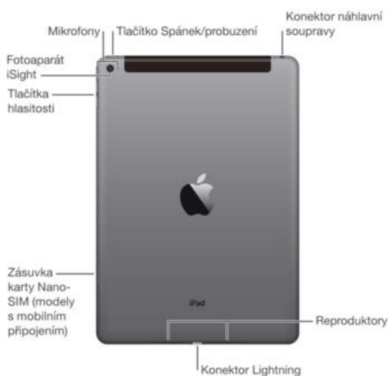
Obr. 3 - Zadní strana iPadu Air 2 (iPad User Guide, 2015)
