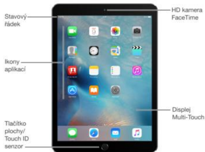
Obr. 1 - Přední strana iPadu Air 2 (iPad User Guide, 2015)
