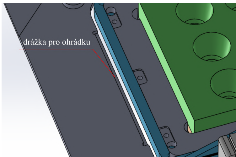
Obrázek 2.13: Dvě drážky v základně pro ohrádku. Snímek byl pořízen v programu SolidWorks.
