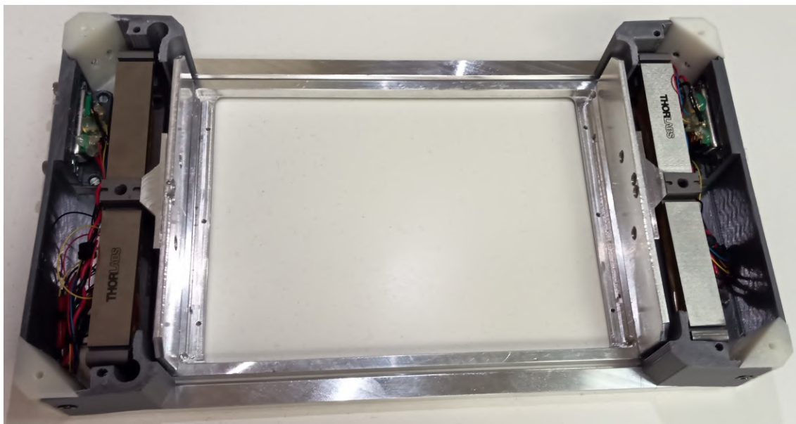
Obrázek 2.34: Vyrobený piezostolek s odejmutými horními kryty.
