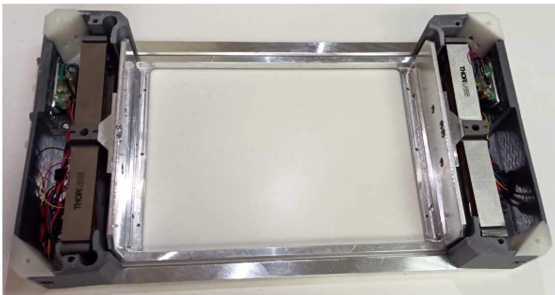
Obrázek 2.34: Vyrobený piezostolek s odejmutými horními kryty.
