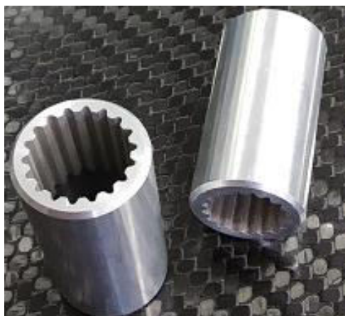
Obr. 3.20: Hliníkové vložky (EN AW 7075) s evolventním drážkováním
