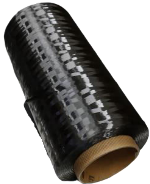
Obr. 2.2: Uhlíkový roving [zdroj vlastní]
