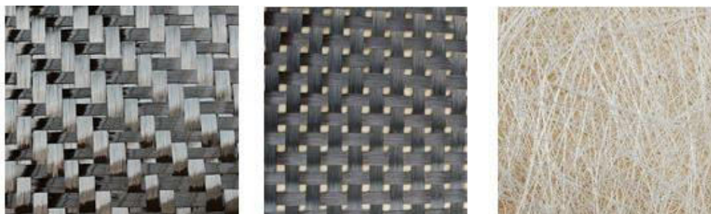
Obr. 2.3: Keprová vazba uhlíkové tkaniny (vlevo), vazba plátno uhlíkové tkaniny (uprostřed), skelná rohož (vpravo) [zdroj vlastní]
