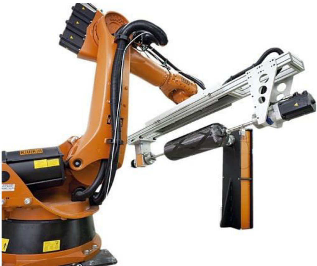
Obr. 2.16: Navíjení pomocí robotu Kuka [14]
