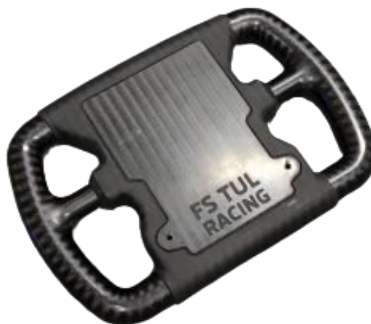
Obr. 2.14: Volant vyrobený pomocí lisování v autoklávu [zdroj vlastní]
